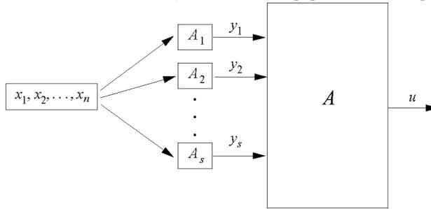
Рис. 2. Комплекс формальных нейронов, реализующий булеву функцию  $u = f(x_1, x_2, \dots, x_n)$
