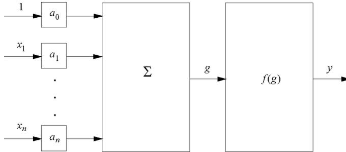
Рис. 1. Общая схема функционирования формального нейрона
