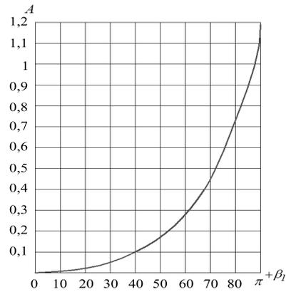
Рис. 3. График изменения единичной функции температурного поля  $t_0 = f(A)$  при  $0 \leq +\beta_1 \leq \pi$
