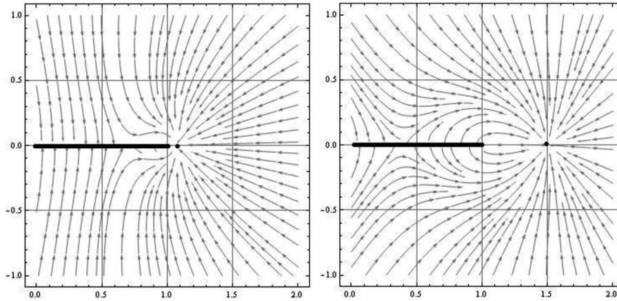
Рис. 2. Линии тока жидкости к скважине, расположенной в точке  $(1.05, 0)$  (слева) и  $(1.5, 0)$  (справа) при значении  $F_{CD} = \infty$
