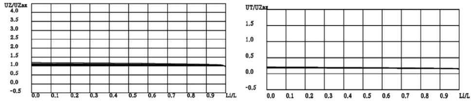
Рис. 2. Осевая и окружная составляющие скорости вдоль канала, угол  $\alpha = 10^\circ$
