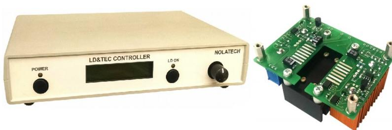
Рис. 4. Драйверы лазерных диодов
