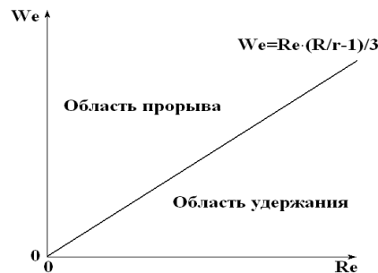
Рис. 2. Область прорыва и область удержания пузыря сеткой в плоскости (We, Re)
